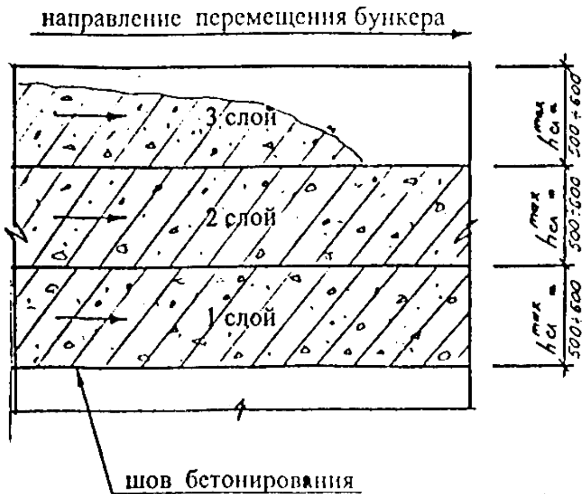
Рис.2. Схема послойного бетонирования
