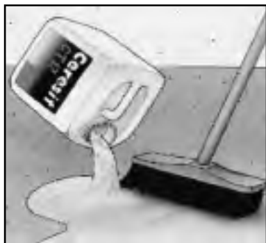
Рисунок 22. Нанесение слоя грунтовки.
