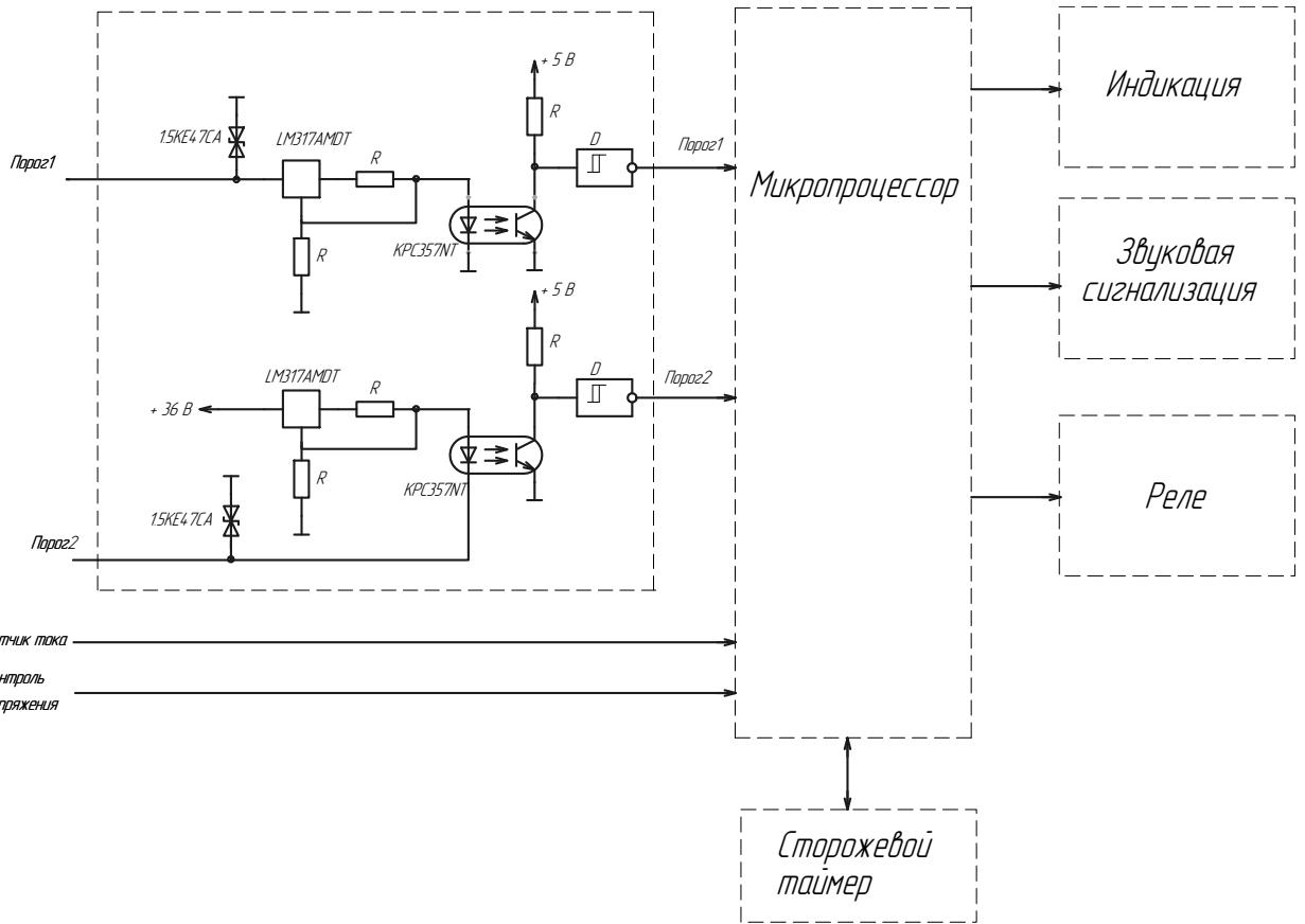
Рисунок 1.2 - Плата управления блоков. Схема функциональная
