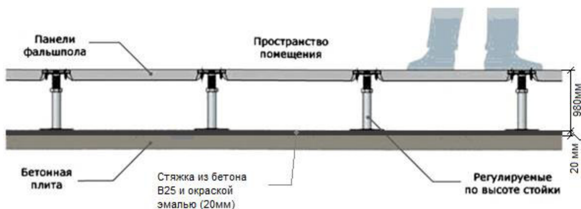
Рисунок 1. Система фальшпола
