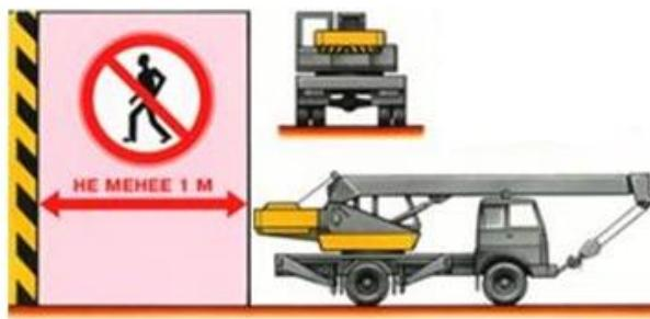
Рис.18. Схема установки крана вблизи препятствий
