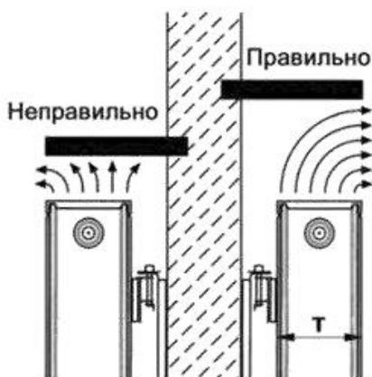
Рис.22 Схема установки панельного радиатора под подоконником
