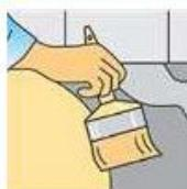
Перед укладкой плитки нанести грунтовку независимо от вида основания. Грунтовка глубокого проникновения или адгезионная эмульсия наносится широкой кистью или малярным валиком. На участ-
