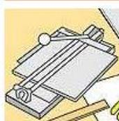
Для получения прямой кромки у крайних плиток следует пользоваться станком для резки плитки. Сначала нанести рискну на лицевой стороне, затем переломить плитку по кромке.
