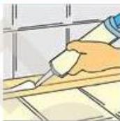
Все деформационные, угловые и краевыестыки заделать эластичной уплотнительной массой, например, силиконом. Края плитки заклеить малярной лентой с обеих сторон. Нанести силикон. Разгладить силикон большим пальцем, смоченным в моющем средстве, и оторвать малярный скотч, наклоняя его назад и в сторону от шва.
