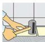
Плитка вжимается в клей легким вращающим движением. Для сохранения необходимого одинакового расстояния между плитками использовать крестовидные распорки. При укладке слегка постучать по плитке резиновым молотком.
