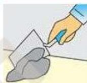
Развести клей, при необходимости выдержать определенное время, затем нанести на основание кельмой или мастерком. Рекомендуется использовать готовые kleевые смеси. При укладке плитки на ДСП или пол с подогревом использовать эластичный клей.
