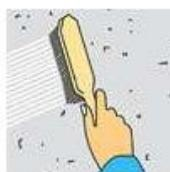
Все несущие поверхности должны быть чистыми, без пыли, ровными, сухими и иметь достаточную несущую способность.
