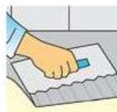
Расшить kleевую массу гребенчатым шпателем до образования ровной поверхности. В зависимости от времени схватывания клея, за один заход укладывается 1-1,5 кв. м. Расшивка зависит от обратной стороны плитки, ее размера и основания.
