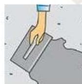
Небольшие трещины и неровности зашпаклевать с помощью мастерка или кельмы или заделать с помощью выравнивающей массы.
