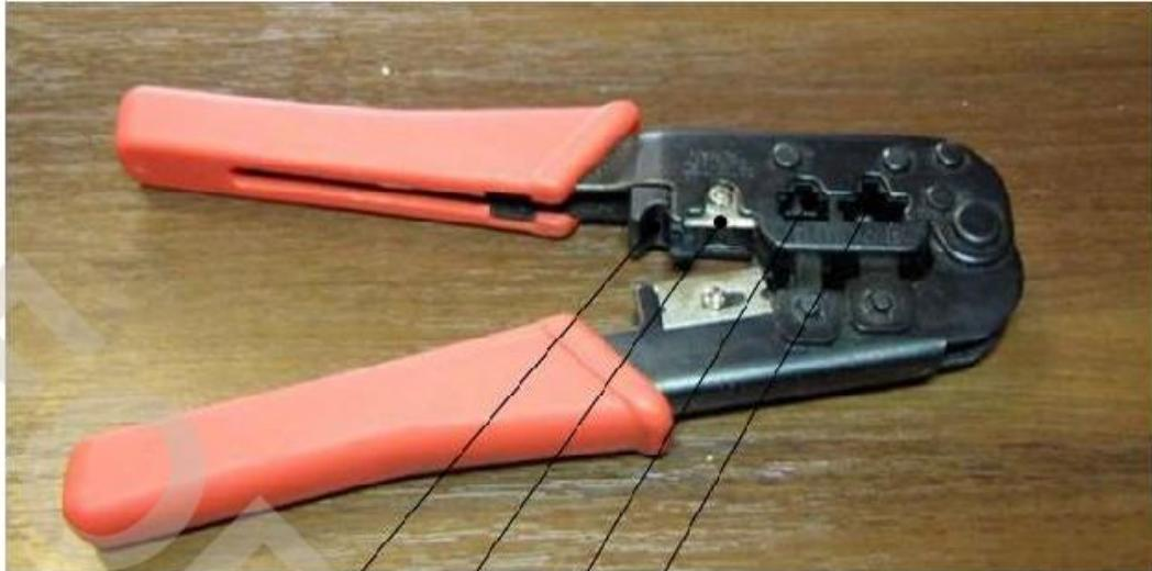
Рисунок 3 - Обжимной инструмент для соединителей RJ45, RJ12
