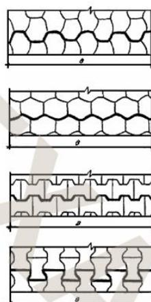
Рис.4. Расположение швов расширения в покрытии тротуара
