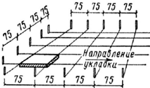
Рис.3. Схема разбивки для укладки плит тротуара
