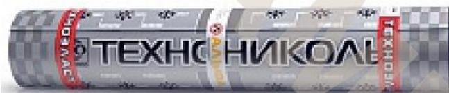
Шуманет-100Комби – применяется для гидроизоляции и снижения ударного шума при устройстве полов «плавающего» типа. Материал состоит из слоя стекловолкна, пропитанного битумом, на который нанесён искусственный войлок из полимерного синтетического волокна с высокими показателями звукоизолирующих свойств.
